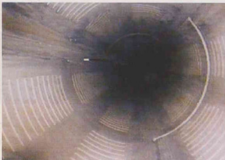
Trinkwasserbrunnen setzen sich mit biologischen Filmen zu (links). Ultraschall macht den Schacht wieder blitzblank (rechts).
