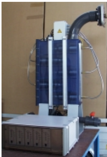
Abb. 3: Hochleistungs-Ultraschallreaktor (Frequenz 20 kHz, 5 kW Leistung) der Fa. WAVES Wasser und Umwelttechnologien GmbH, Hamburg.
